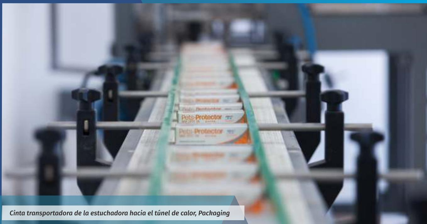
Cinta transportadora de la estuchadora hacia el túnel de calor, Packaging
